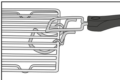
Abb. 1: Einhaken der Zange **10** beim Gitterrost **8**
