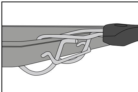
Abb. 2: Einhaken der Zange **10** beim Backblech **9**
