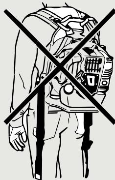
■ Ispравним podešavanjem pojaza za nošenje ② i uređaja znatno se olakšava rad. Pojaz za nošenje ② postavite na optimalan radni položaj.
