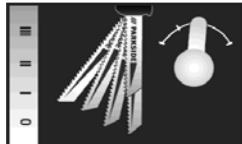
Za pomocą przełącznika skoku wahadłowego [12] możesz nastawić ruch wahadłowy brzeszczotu [14]. Bez ruchu wahadłowego (pozycja „0”) osiągniesz dokładne i starannie obrabione krawędzie cięcia. W przypadku cienkich przedmiotów obrabianych wyłącz skok wahadłowy.
