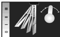
Pomoću prekidača na bazi viska za podizanje **[12]** možete namjestiti njihanje lista pile **[14]**. Bez njihanja (pozicija „0“) ostvarit ćete fine i čiste rubove reza. Kod tanjih predmeta isključite klatno podizanje. S aktiviranim klatnim podizanjem (pozicija 1 – 3) brže ćete raditi.
