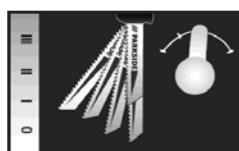
Kyvadlový pohyb plôvaciaho listu **[14]** môžete nastaviť pomocou spínača kyvadlového zdvihu **[12]**. Bez kyvadlového pohybu (poloha „0“) docielite jemné a čisté rezné hrany. U tenkých obrábaných predmetov kyvadlový zdvih vypnite.
