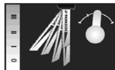
Spínačem kývavého zdvihu **[12]** můžete nastavit kývavý zdvihový pohyb pilového listu **[14]**. Bez kývavého zdvihového pohybu (poloha „0“) docílítě jemných a čistých řezných hran. U tenkých obrobků odstavte kývavý zdvih.
