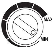
Le régulateur de température ③ peut être réglé en continu. Il suffit de tourner dans le sens des aiguilles d'une montre pour régler une température supérieure, en tournant dans le sens inverse des aiguilles d'une montre, une température inférieure est réglée.
