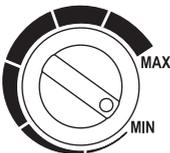
Der Temperaturregler ③ ist stufenlos einstellbar. Durch Drehen im Uhrzeigersinn wird eine höhere Temperatur eingestellt, durch Drehen gegen den Uhrzeigersinn wird eine niedrigere Temperatur eingestellt.
