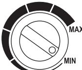
Der Temperaturregler ③ ist stufenlos einstellbar. Durch Drehen im Uhrzeigersinn wird eine höhere Temperatur eingestellt, durch Drehen gegen den Uhrzeigersinn wird eine niedrigere Temperatur eingestellt.
