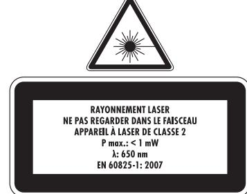
■ Ne pas regarder directement dans le faisceau laser ou dans l'ouverture dont il émerge.
