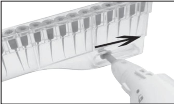
l'embout de nettoyage ② se détache ainsi de l'axe de rotation ③ et tombe.
