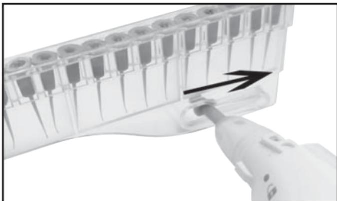
Nastavak za čišćenje ② će se na taj način odvojiti od trna držača ③ i ispasti.
