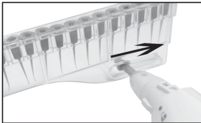
l'embout de nettoyage **2** se détache ainsi de l'axe de rotation **3** et tombe.
