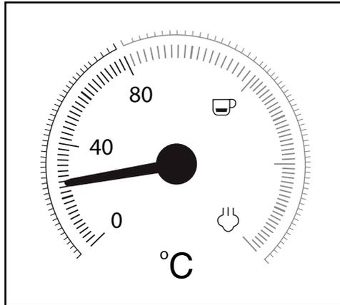
Sobald Sie das Gerät einschalten, beginnt das Gerät aufzuheizen, bis der Zeiger ungefähr in der Mitte zwischen 80°C und „☕“ steht.
