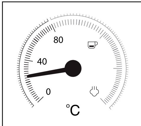
След включване уредът започва да загрява, докато стрелката застане приблизително в средата между  $80\text{ }^{\circ}\text{C}$  и „
