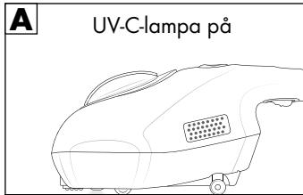
Om säkerhetsbrytarna förlorar kontakten med underlaget aktiveras den automatiska frånkopplingsfunktionen och UV-C-lampan **8** släcks (bild B och C).
