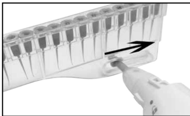
Końcówka czyszcząca **2** zostaje zdjęta w ten sposób z trzpienia do elementów nasadzanych **3** i odpada.
