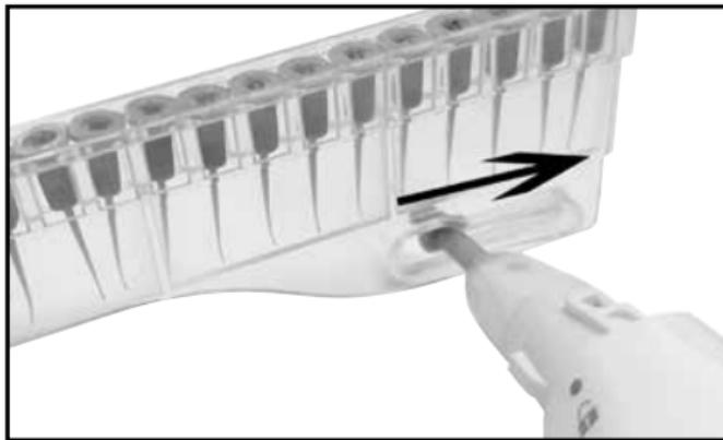
Nástavec na čištění **2** se tak uvolní z nástrčného hrotu **3** a odpadne.
