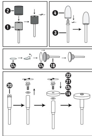
2 x Aufspanndorn (Trennscheibe **21**/ Schleifscheibe **14**/Schleifpapier **17a**) **20**
