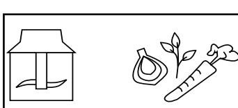
Le hachoir composé de la lame ⑦, du bol ⑧ et du couvercle du bol ⑨ vous permet de hacher des fines herbes ou des aliments plus durs. Nous recommandons d'opérer le hachoir au max. 1 minute d'affilée et de le laisser refroidir.
