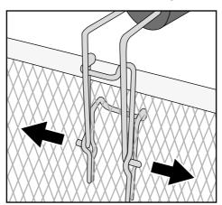
Ziehen Sie den Haltegriff • nach hinten, so dass dieser einrastet:
