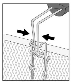
Lösen Sie dann die zusammengedrückten Stäbe des Haltegriffs  $oldsymbol{\mathbb{O}}$ , so dass die Haltebolzen durch die Ösen ragen:
