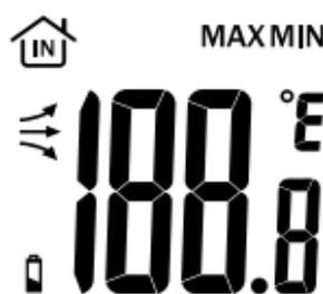
Die von der Temperaturstation gemessene Innentemperatur wird mit einer Teilung von einem Zehntelgrad angezeigt. Oben rechts erscheint die Temperatureinheit °C (für Grad Celsius). Die Temperatureinheit kann auch auf °F (Grad Fahrenheit) umgestellt werden.
