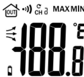
Die Außentemperatur wird mit einer Teilung von einem Zehntelgrad angezeigt. Oben rechts erscheint die Temperatureinheit  $^{\circ}\text{C}$  (für Grad Celsius).
