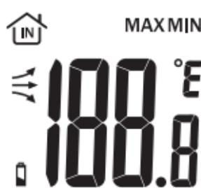
MAXMIN De door de thermometer gemeten binnentemperatuur wordt met een nauwkeurigheid van één tiende graad weergegeven. Rechtsboven wordt de temperatuureenheid °C (voor graden Celsius) weergegeven. De temperatuureenheid kan ook worden ingesteld op °F (graden Fahrenheit).
