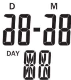
Pod zobrazením **D** se zobrazí datum aktuálního dne a pod zobrazením **M** se zobrazí datum aktuálního měsíce. Vpravo vedle zobrazení **DAY** (anglicky pro den) se zobrazí zkratka pro aktuální den v týdnu.
