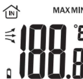
Vnútorná teplota nameraná meteostanicou sa zobrazuje s rozdelením na desatinu stupňa. Hore vpravo sa zobrazuje jednotka teploty °C (pre stupeň Celzia). Jednotka teploty môže byť prestavená aj na °F (stupeň Fahrenheita).
