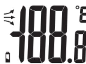
De buitentemperatuur wordt met een nauwkeurigheid van één tiende graad weergegeven. Rechtsboven wordt de temperatuureenheid °C (voor graden Celsius) weergegeven. De temperatuureenheid kan ook worden ingesteld op °F (graden Fahrenheit).
