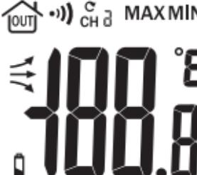
MAXMIN Temperatura zewnętrzna wyświetlna jest z podziałką wynoszącą jedną dziesiątą stopnia. U góry z prawej strony pojawia się jednostka temperatury °C (stopnie Celsjusza). Jednostkę temperatury można także zmienić na °F (stopnie Fahrenheita).
